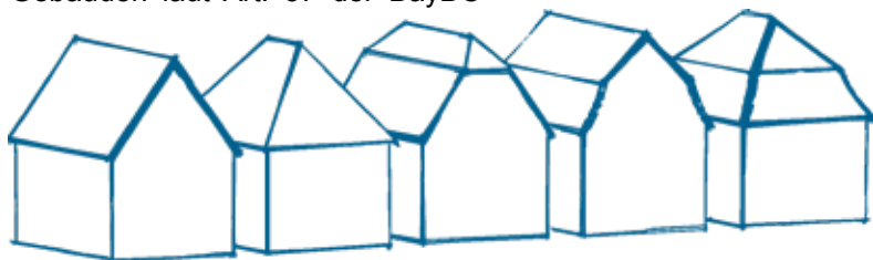
Satteldach, Walmdach, Krüppelwalmdach, Mansardgiebeldach, Mansarddach
